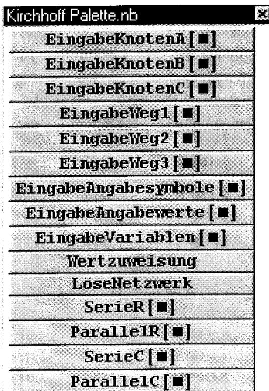
Ein *Knoten* wird durch zu- und abfließende Ströme beschrieben, ein *Weg* durch die Spannungen und Spannungs-abfälle entlang eines geschlossenen Kreises.
